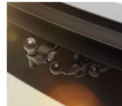
Crochet d'attelage à déclenchement électrique.
