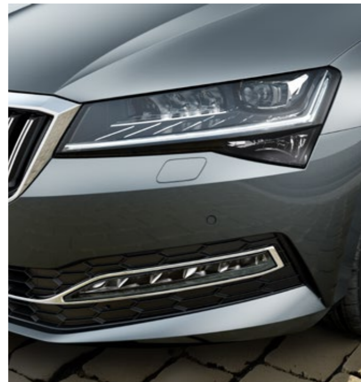
Phares avant Full LED avec technologie "Matrix Beam" et gestion automatique des feux.
