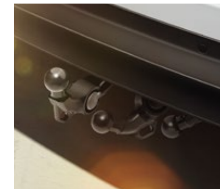
Crochet d'attelage à déclenchement électrique.
