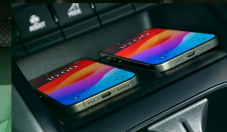
**Dispositif Phonebox : recharge par induction réfrigérée pour 2 téléphones délivrant une puissance de 15W par téléphone**
