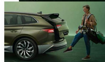
**Hayon de coffre électrique incluant ouverture mains libres (Virtual Pedal)**
