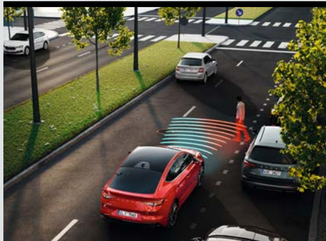
Front Assist : freinage automatique d'urgence incluant la protection des piétons avec Assistance anti-collision et Turn Assist
