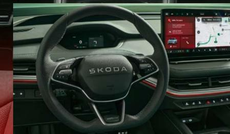
Volant 3 branches sport en cuir multifonctions chauffant avec palettes, détection des mains
